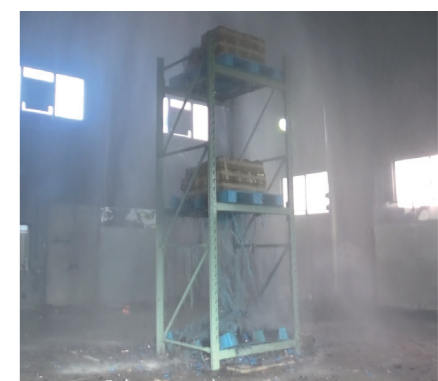
スプリンクラー設備によるリチウムイオン蓄電池の消火実験
