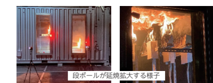
倉庫模型を用いた燃焼実験
