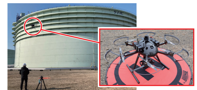
石油タンクのドローン点検に係る実証実験（苫小牧東部国家石油備蓄基地において）
