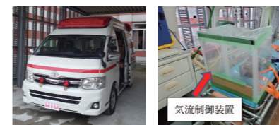
実験用救急車と気流制御装置の試作機
